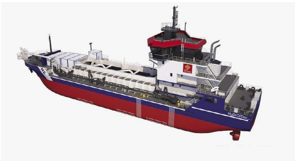
*Drague hybride intégrant une pile à combustible et permettre d'économiser 20 % de gasoil.*
