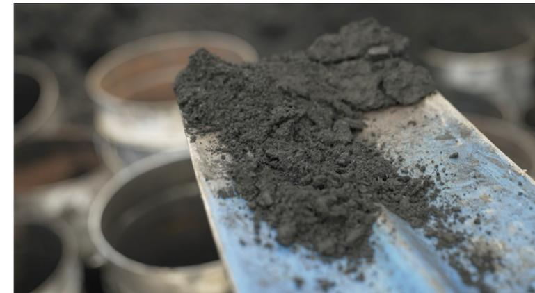
> Le biochar, co-produit de la production d'hydrogène par thermolyse de la biomasse
